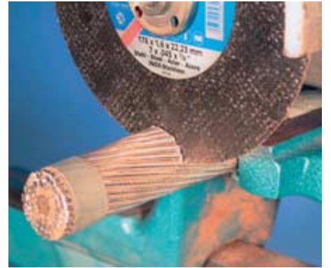
Jäysteetön katkaisu komposiittiaineissa (esim. teräsvaippainen alumiini).
