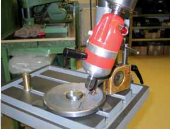
Vinojen poranreikien työstö
