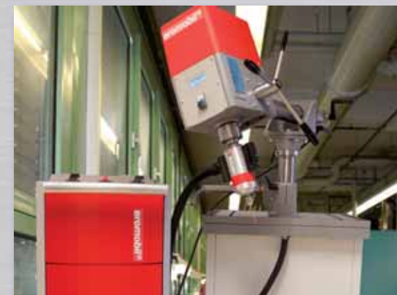
Työstö kaikissa kulma-asennoissa tai suurten rakenneosien työstö säteistyöstöyksiköllä
