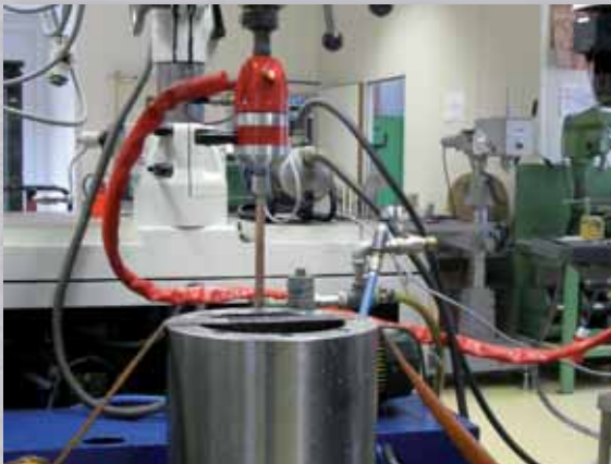
Katkennut kierretappi jäähdytysvesivaipassa, työstäminen automaattisella syöttöliikkeellä
