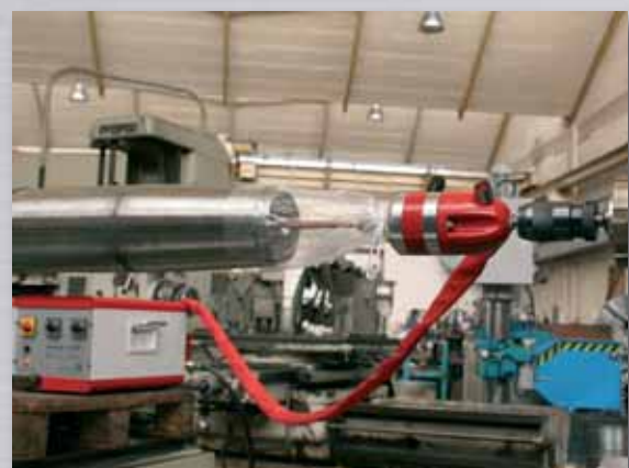
Vaakasuntainen työstö porakoneella. Poran sijaan työstölaitteen värähtelypää kiinnitetään koneeseen
