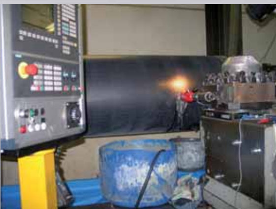
Työstö CNC-sorvilla. Syöttöliikkeen säätö tapahtuu manuaalisesti käsipyörällä
